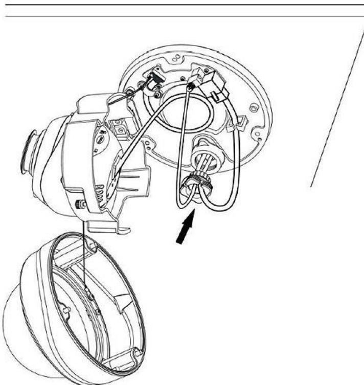
**Schritt 5:** Lösen Sie die Kamerakopf Befestigungsschraube. Drehen Sie die Objektivereinheit in die gewünschte Richtung. Ziehen Sie die Kamera Kopfschrauben-Befestigung wieder an.
