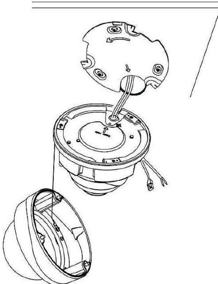
**Schritt 3:** Drehen Sie die Kameraeinheit entsprechend der Richtung wie in der Abbildung dargestellt und dann montieren die Kameraeinheit an der Halterung mit den mitgelieferten Schrauben.
