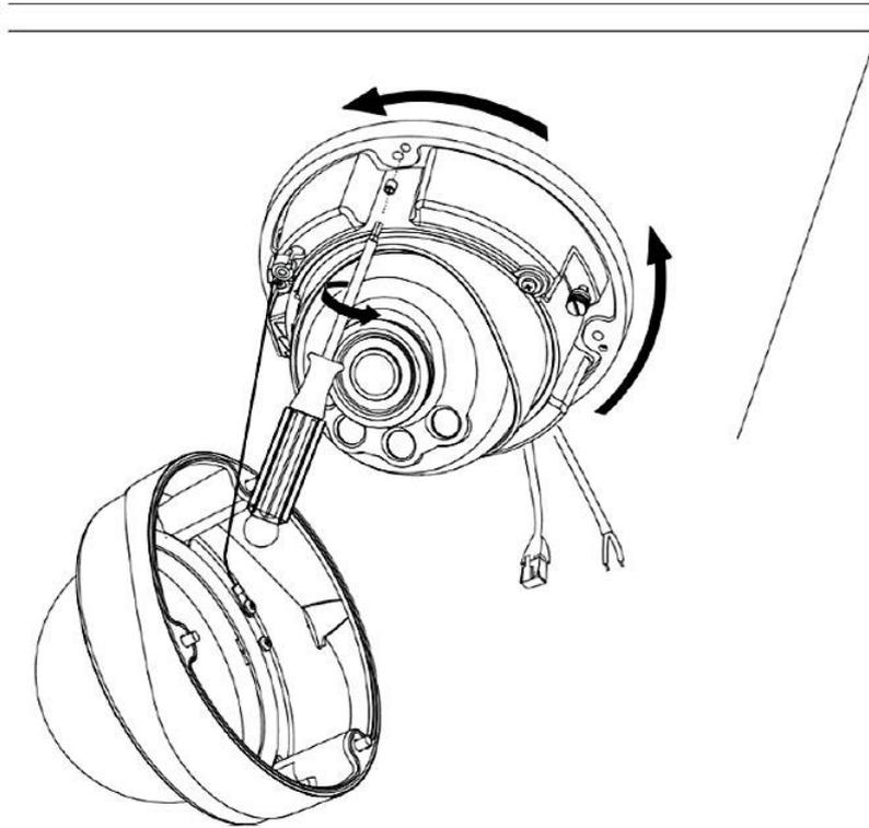
**Schritt 4:** Verbinden Sie das Ethernet-Kabel und die Stromquelle durch die Decke oder an der Wand, dann die Kameraeinheit an der Halterung befestigen.
